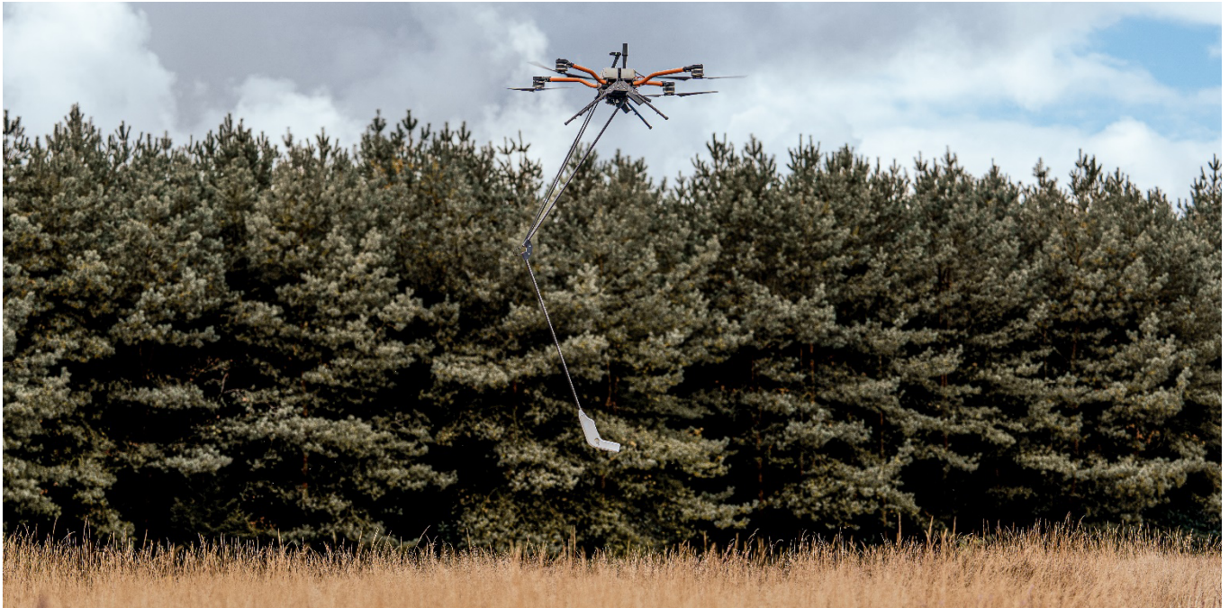
EIN MAGNETOMETER - BEFESTIGT AN EINER DROHNE - MISST RICHTUNG UND STÄRKE DES MAGNETFELDES UND DIE SOFTWARE „MINESWEEPER“ WERTET DIE DATEN AUS.
